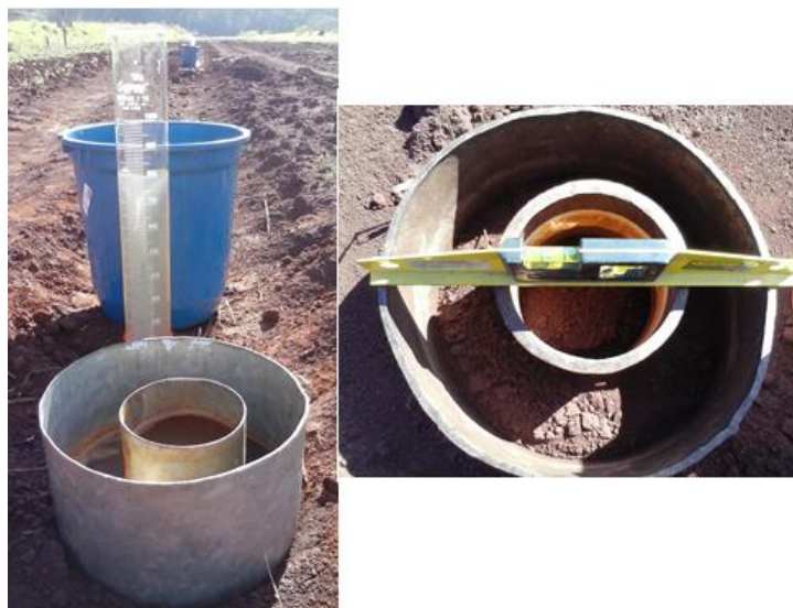
Figura 20. Determinação da velocidade de infiltração básica da água no solo (VIB) através do método dos anéis concêntricos.
