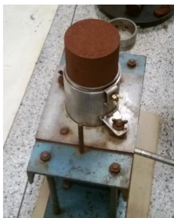
Figura 18. Ensaio de Proctor, amostra de solo sendo retirada do cilindro com o auxílio do extrator de amostras.
