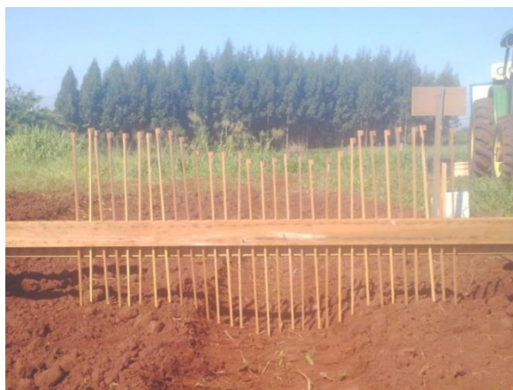
Figura 21. Perfilômetro utilizado na medição de área mobilizada, área 1.
