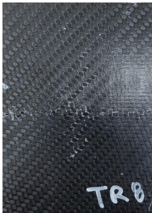
Figura 49 - Imagem de um corpo de prova representativo após o ensaio de CAI.
