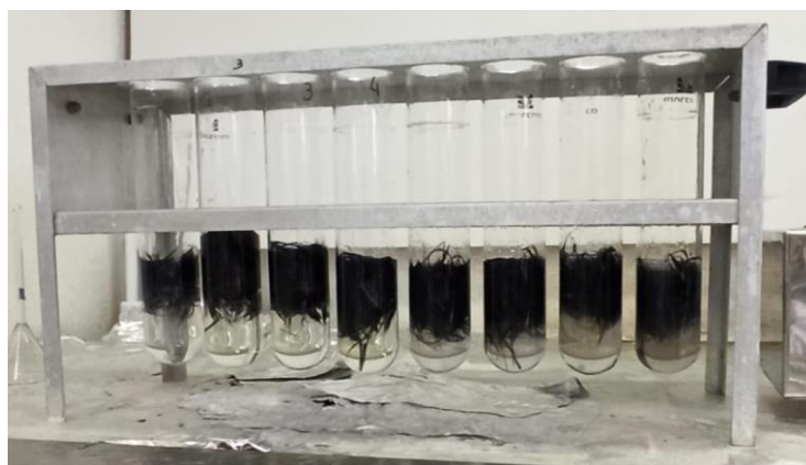
Figura 19 - Fibras de carbono restantes após a neutralização do ácido sulfúrico.
