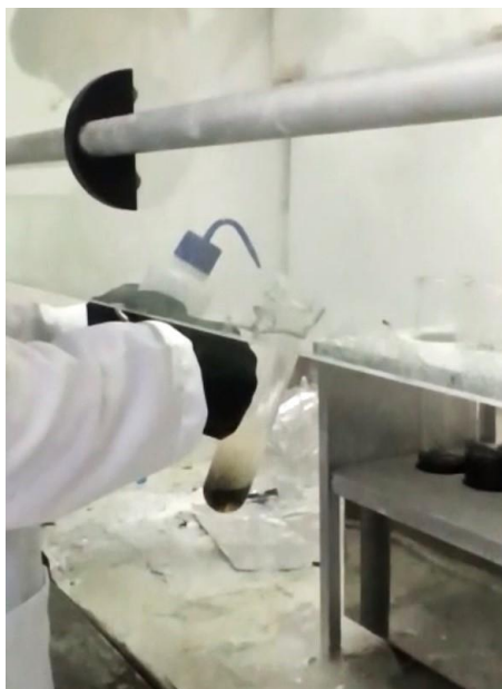
Figura 18 - Utilização do peróxido de hidrogênio para neutralização do ácido sulfúrico.
