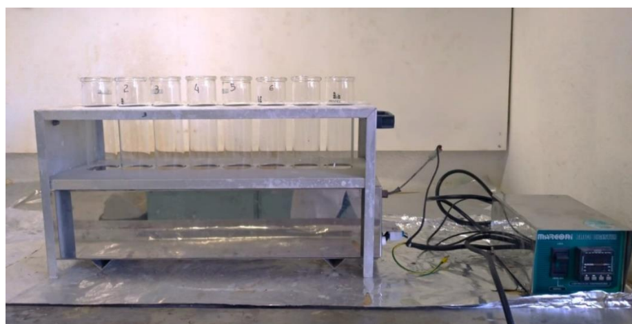
Figura 17 – Bloco digestor: a esquerda, tubos de ensaio inseridos no bloco digestor, a direita o controlador de temperatura.
