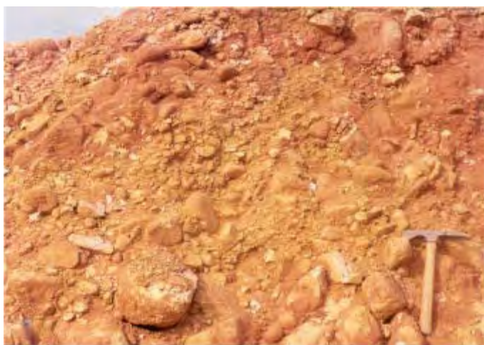
Foto 5.2 (b): Fácies Gcm : conglomerado suportado por clastos, maciço (ponto 198).
