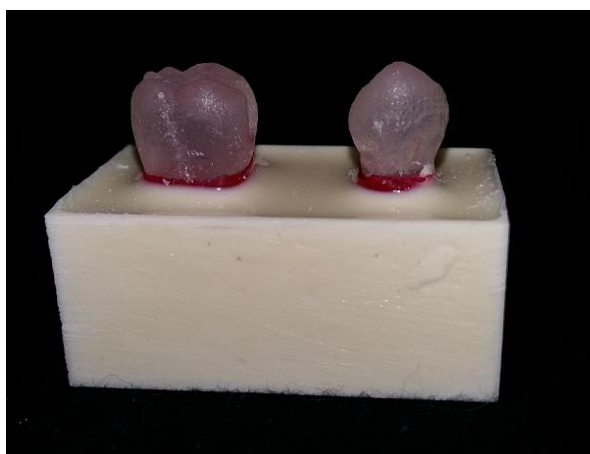
Figura 5 - Base de poliuretano com dentes em époxi simulando os pilares dentais
