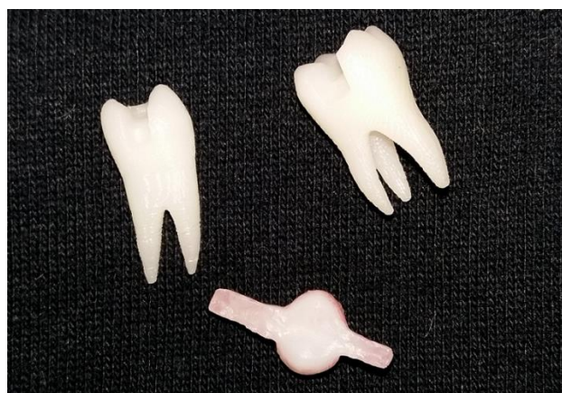
Figura 2 - protótipos em ABS impressos 3D – primeiro pré-molar, primeiro molar e prótese
