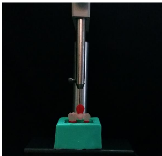
Figura 4 - Posicionamento do conjunto sobre o molde para inclusão dos pilares em resina de poliuretano
