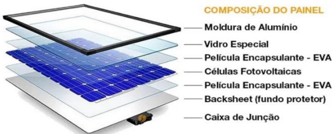
Figura 8 – Composição do Painel Solar.
