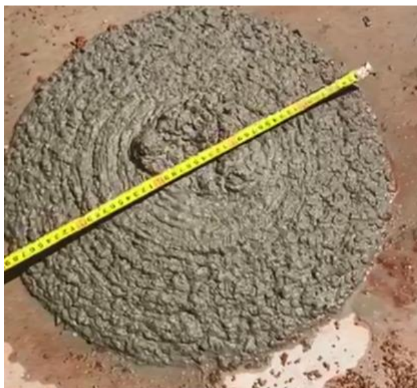
Figura 5: Concreto espalhado pelo cone de teste de flow.
