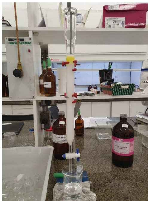
Figura 8 – Purificação por coluna cromatográfica Sephadex HL-20 usando etanol como fase móvel.
