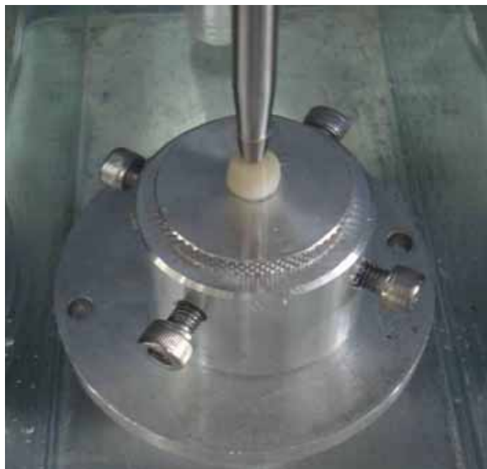
Figura 18 – Ilustração da aplicação do teste de resistência à carga compressiva.
