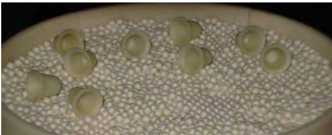
Figura 11 - Aspecto das infra-estruturas logo após sinterizadas a 1530°C.
