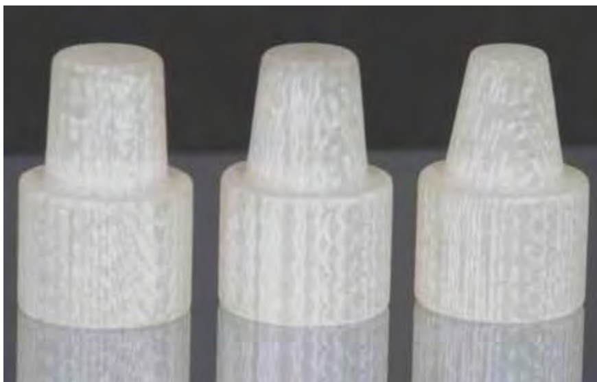
Figura 6 – Preparos realizados em resina epóxica reforçada por fibras de vidro.
