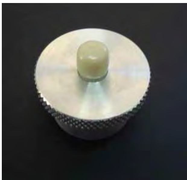
Figura 16 – Corpos de prova posicionado na base de alumínio para o envelhecimento por CM.
