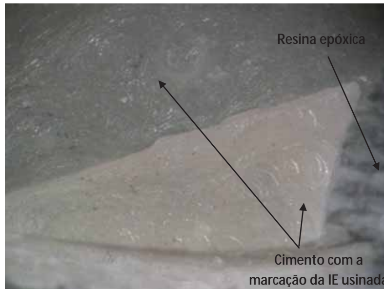
Figura 36 – Imagem em estereomicroscópio da superfície do cimento resinoso com as marcações da usinagem da IE após a fratura (restauração do grupo G20cMOD).
