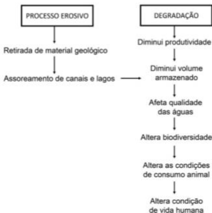
Figura 6 - Degradações geradas por processos erosivos.
