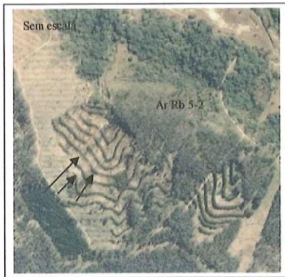
Figura 14 - Fotografia aérea de 2000 evidenciando novos processos erosivos.
