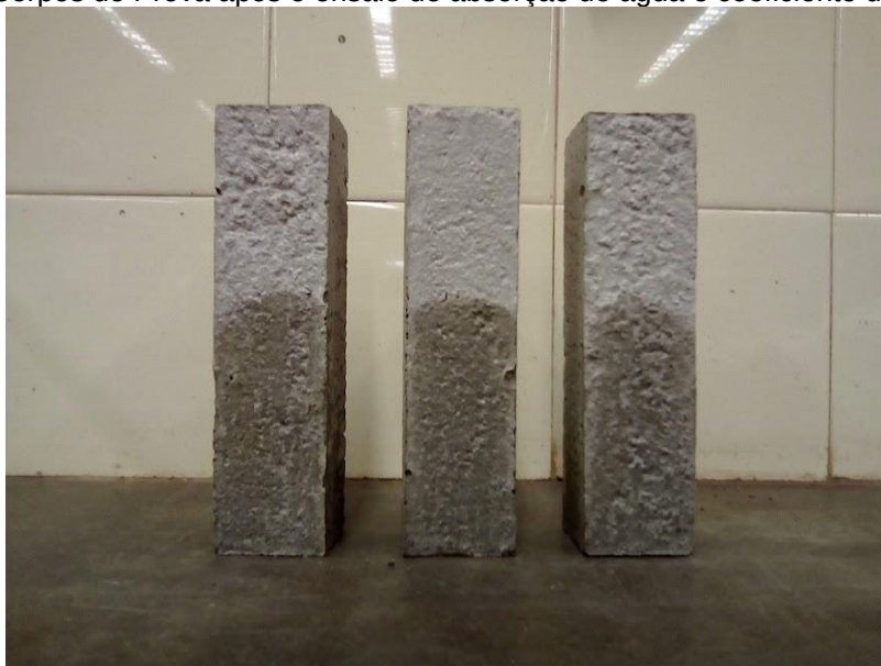
Figura 12 – Corpos de Prova após o ensaio de absorção de água e coeficiente de capilaridade
