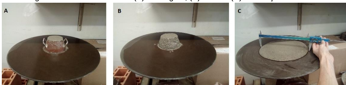
Figura 11 - Ensaio flow table (A) moldagem; (B) início e (C) finalização do ensaio.
