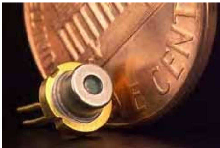
FIGURA 2 – Comparação de tamanho de chip de laser de diodo com uma moeda de um centavo americano (internet 20/out/2005).
