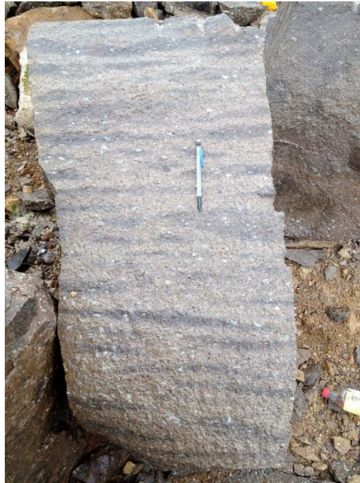
Figura 4. 2.- Bandamento em rocha do tipo ATC, representado por lentes escuras vítreas (fiammes?) em meio a material mais claro microcristalino/devitrificado.
