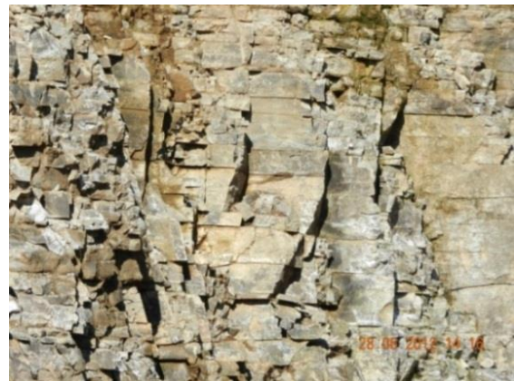
Figura 4. 4. Afloramento típico de rocha do tipo ATC, mostrando disjunção em lajes, comuns na base do derrame.
