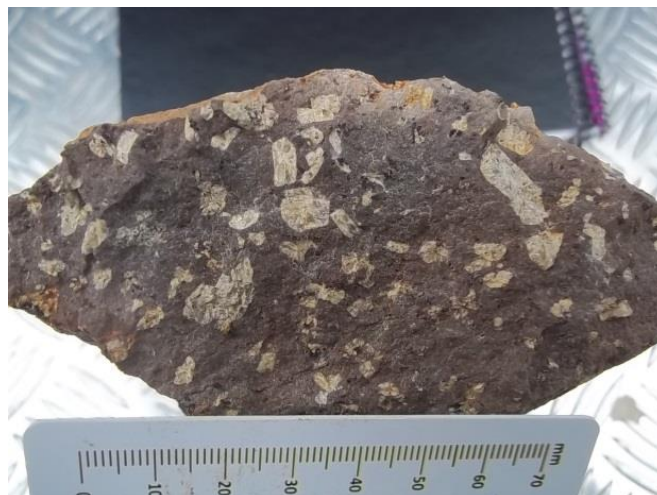
Figura 4. 1.- Rocha do tipo Chapecó mostrando natureza porfirítica, com macrofenocristais euedrais de plagioclásio.
