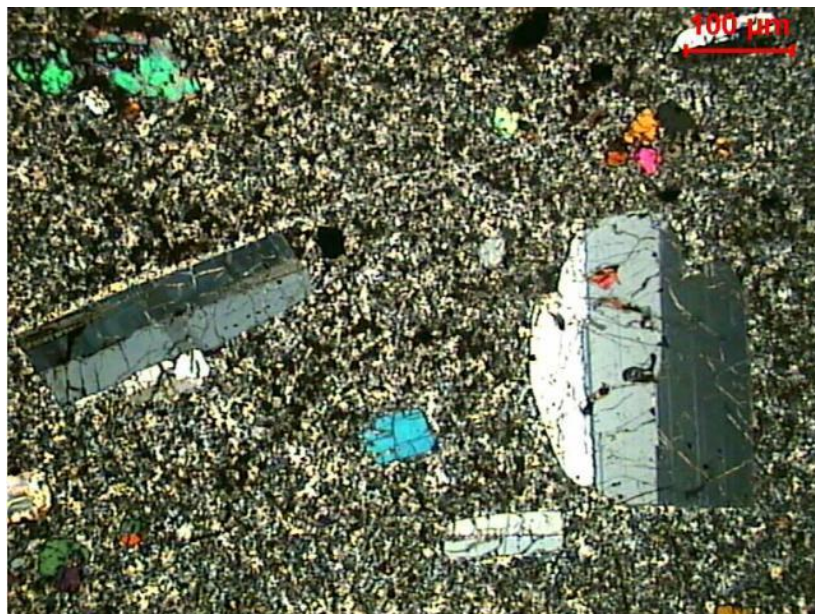
Figura 5. 3.- Fotomicrografia com nicóis cruzados de rocha do tipo Chapecó, com textura vitrofírica, fenocristais de plagioclásio (localização da amostra: Pinhão - PR).
