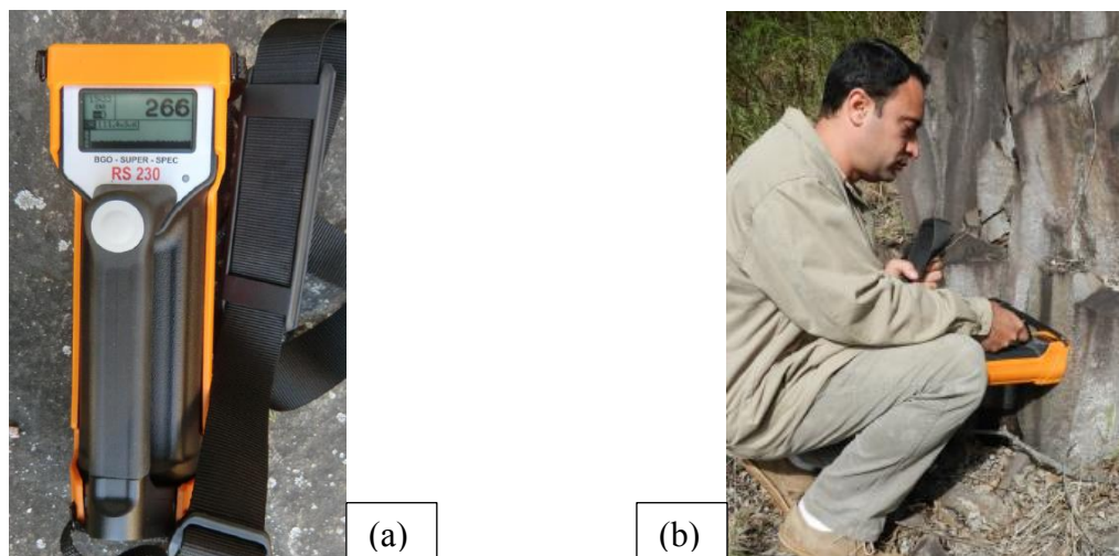
Figura 3. 1.- (a) Gamaespectrômetro portátil modelo RS-230 e; (b) seu modo de utilização no campo. Observar que a leitura foi feita com o equipamento em contato com uma superfície plana do estudado.
