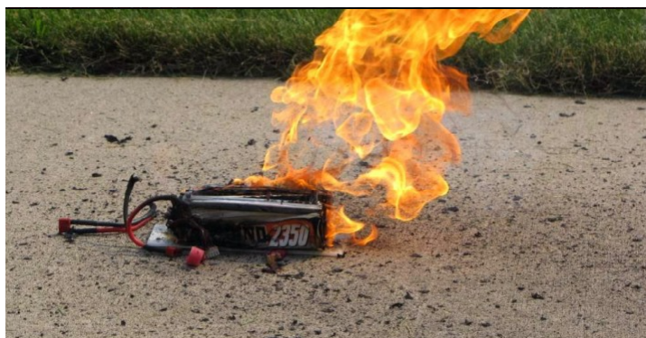
Figura 2 – Bateria após explosão
