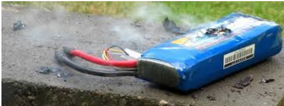
Figura 6 – Bateria de lítio após explosão
