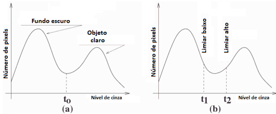
Figura 6 – Histograma em um processo de limiarização (a) simples e (b) multinível.
