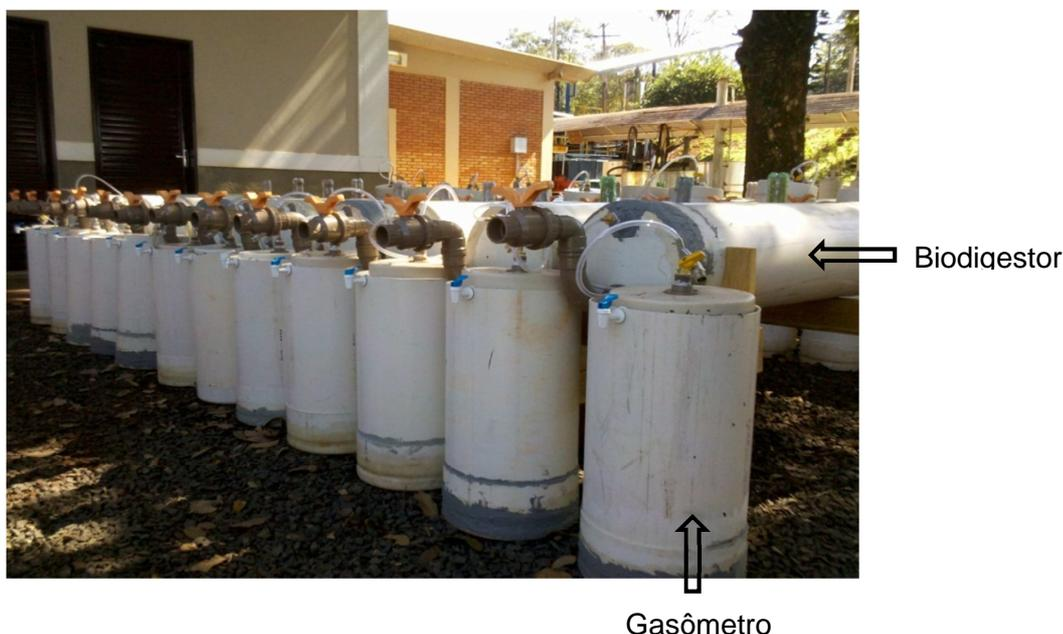
**Figura 2:** Conjunto de biodigestores expostos às condições ambientais.
