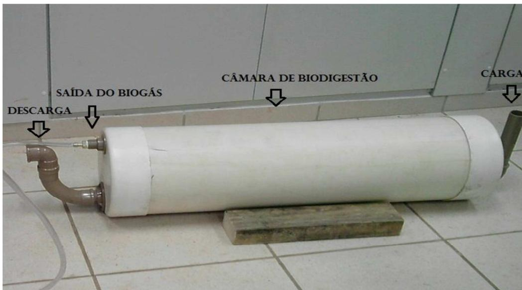
**Figura 1:** Biodigestor Contínuo
