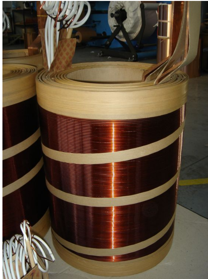
Figura 12: Bobina de transformador. Detalhe da isolação de papel (MCLYMAN, 2004).
