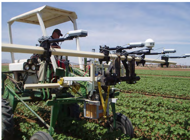
Figura 12 - Coleta de dados com os quatro sensores de refletância Crop Circle ACS-470 montados na frente de um trator na cultura do algodão, Arizona - EUA.
