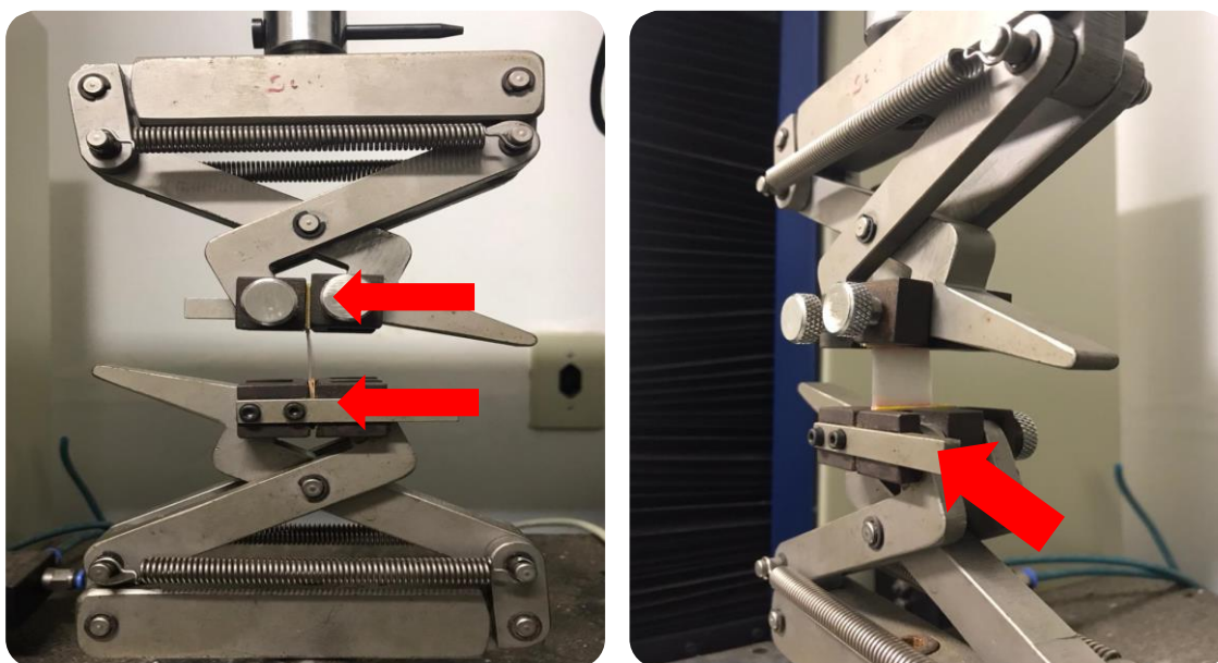
Figura 26 – Amostra de CB fixada na garra com auxílio das lixas P220
