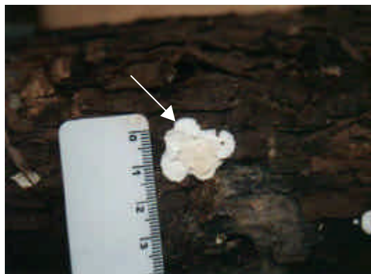
Figura 9. Aspecto do crescimento de Poria spp. em toros de eucalipto.
