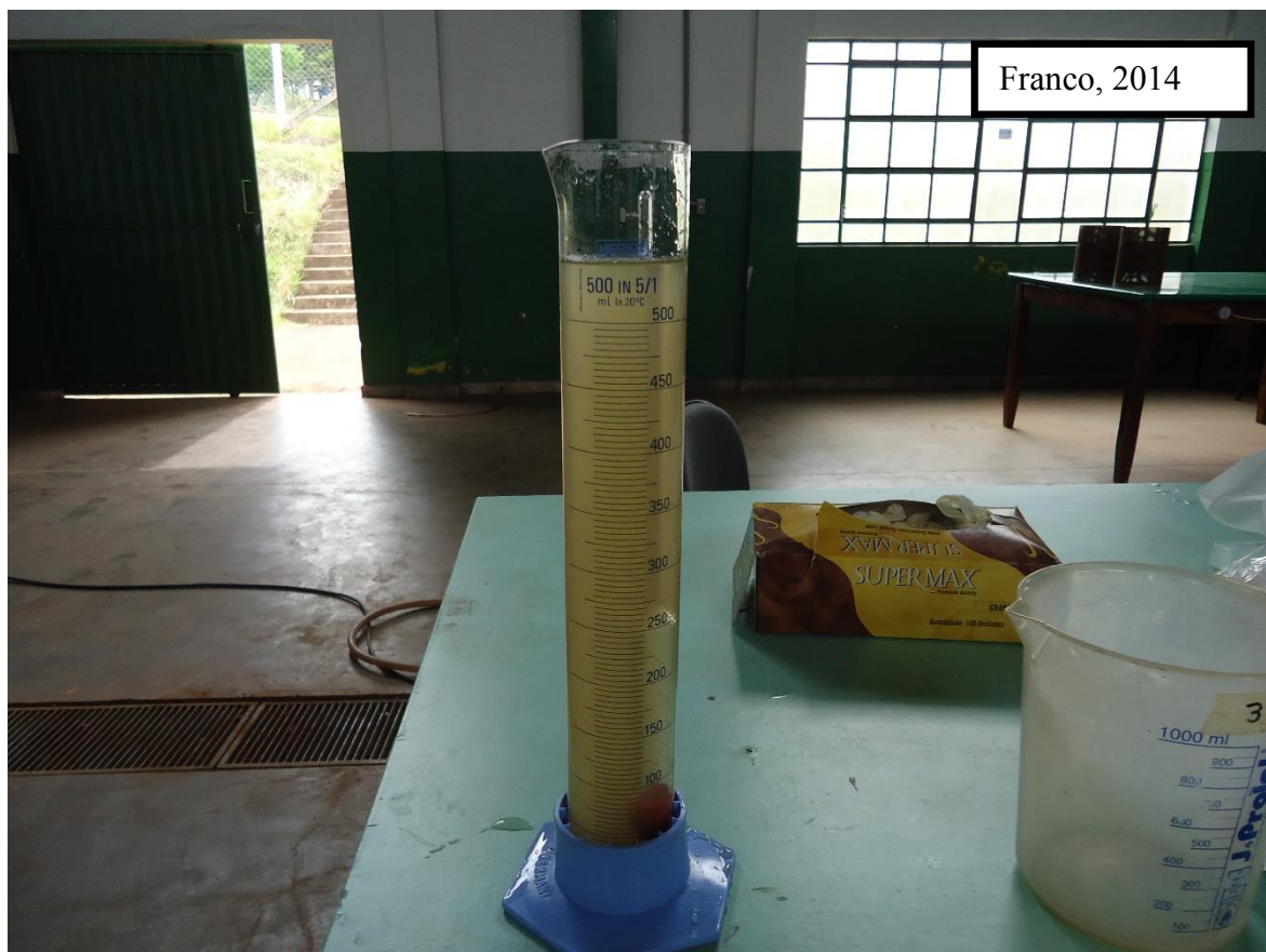
Figura 4. Vista da análise de densidade dos dejetos, Botucatu – SP, 2014.
