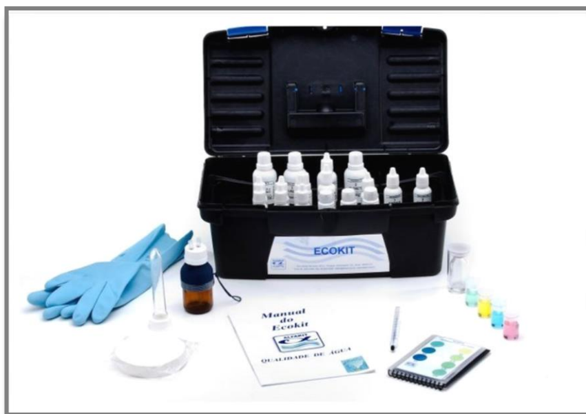
Figura 4 - Imagem ilustrativa do Ecolit utilizado para análise da qualidade da água. Fonte: ALFAKIT.
