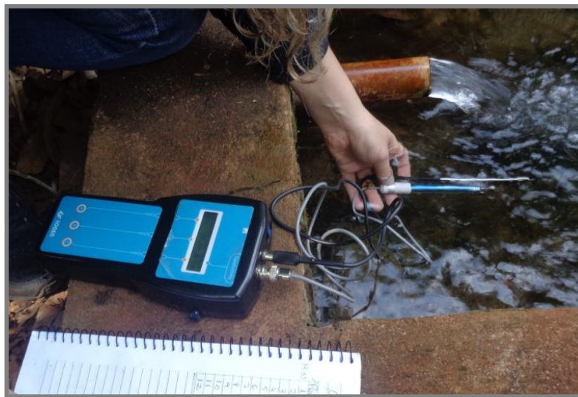
Figura 6 - Equipamento utilizado para medir condutividade elétrica. Fotografia de Mário Sérgio Oliveira, 2015.
