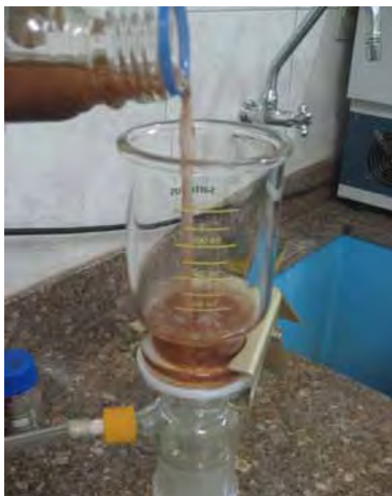
Figura 15. Sistema de ultrafiltração utilizado no processo de extração das amostras de sedimento fortificadas com os inseticidas DFB e TFB.
