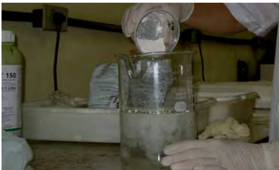
Figura 6. Diluição de formulação comercial de diflubenzuron para o preparo da ração fortificada com os inseticidas diflubenzuron ou teflubenzuron.
