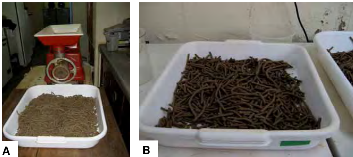
Figura 7. Moedor de carne utilizado para peletizar a ração acrescida dos inseticidas (A) e peletes secos antes do fracionamento (B).
