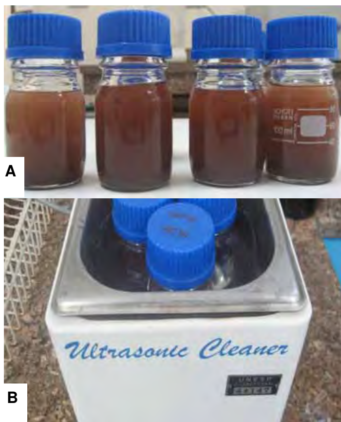
Figura 14. Bateria de testes com diferentes solventes (A) para extração do DFB e TFB nas amostras de sedimento. (B) Aparelho de ultrassom. (C) Sistema de ultrafiltração.
