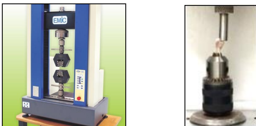
Figura 10: Ensaio mecânico de compressão do colo femoral realizado em máquina EMIC/DL 3000.
