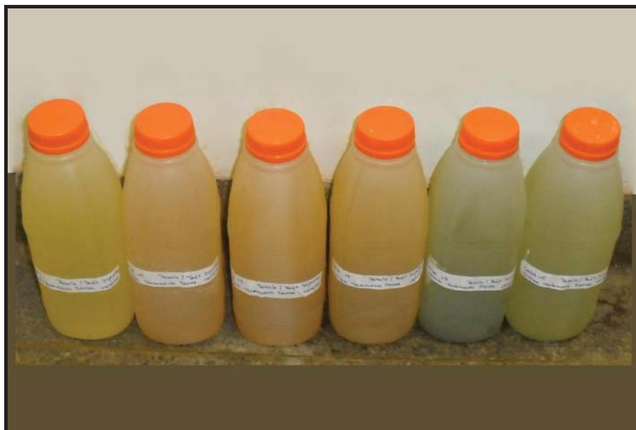
Figura 18: Amostras obtidas em sequência, evidenciando as alterações de coloração desde a entrada do sistema, à esquerda, até a saída do efluente, à direita. Foto: Junho / 2011.
