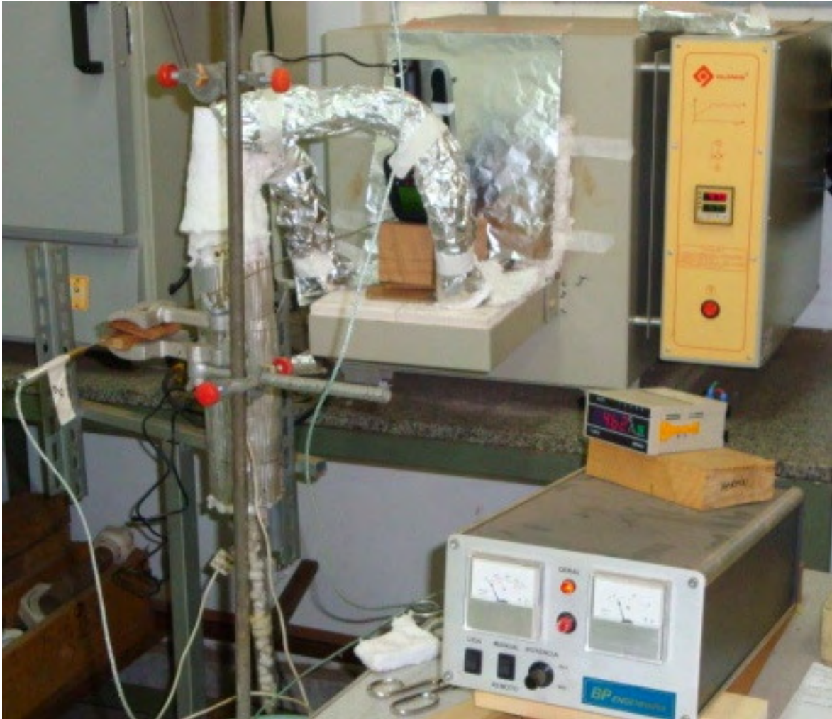
Figura 3.8: Foto do sistema de medida de emissividade, com isolamento térmico dos tubos de N_2 pré-aquecido eletricamente.
