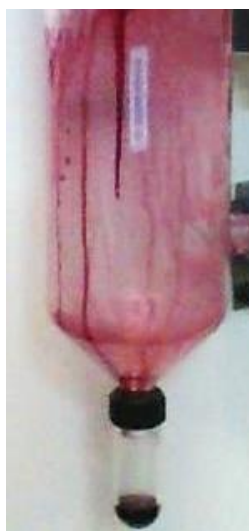
Figura 2.3 Condições de secagem insatisfatórias resultaram no gotejamento da amostra.
