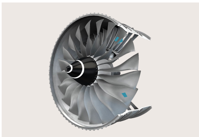
Figura 12 – Desenho 3D do Fan do Motor Rolls Royce Trent 1000.
