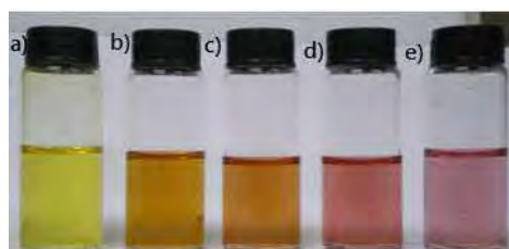
Figura 31- Imagens das suspensões coloidais estabilizadas com pectina: a) NPAg, b)NPAuAg 1:3, c) NPAuAg 1:1, d) NPAuAg 3:1 e e) NPAu.
