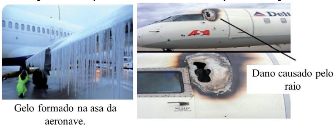
Figura 12 - Exemplos de danos na aeronave causado pelo raio e congelamento
