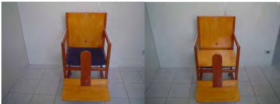
Figura 1 – Cadeira construída para o estudo, com regulagem para apoio de pés, abdutor e com assento de lona e de madeira
