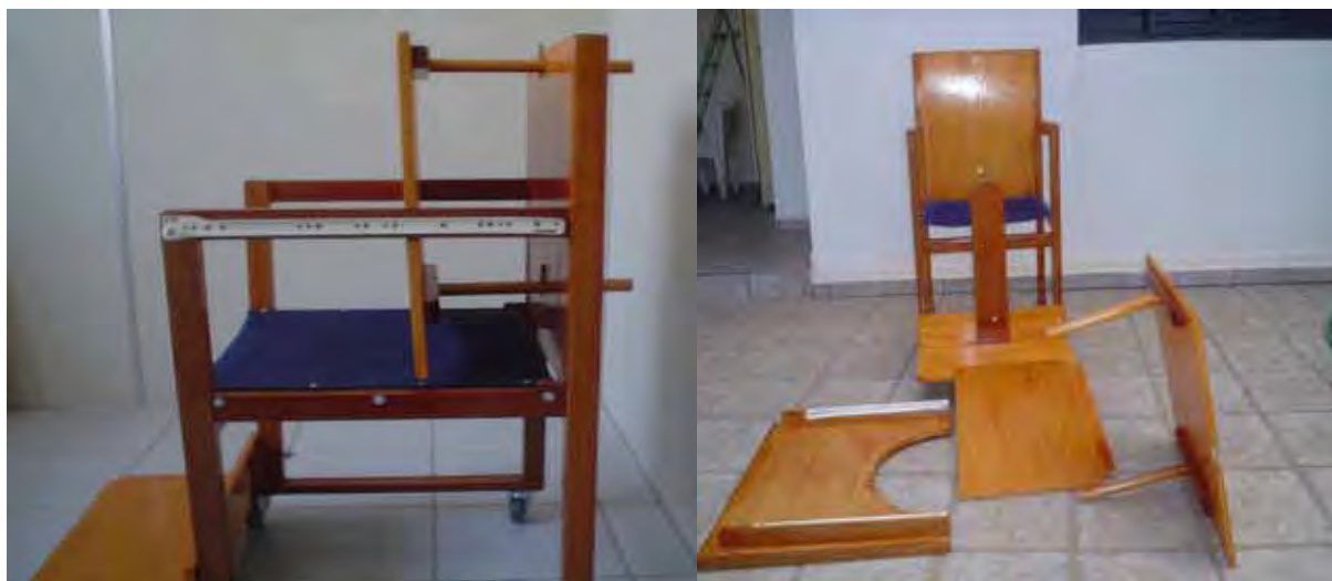
Figura 2 – Cadeira construída para o estudo, com vista lateral da regulagem do encosto e com a bandeja, assento de madeira e encosto separados
