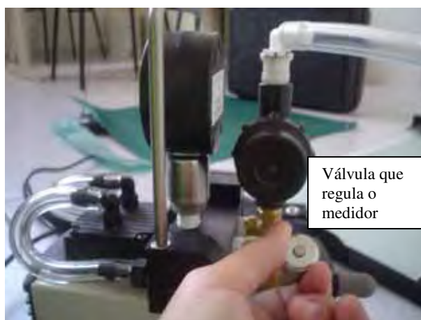
Figura 10 - Válvula que regula o medidor da bomba
