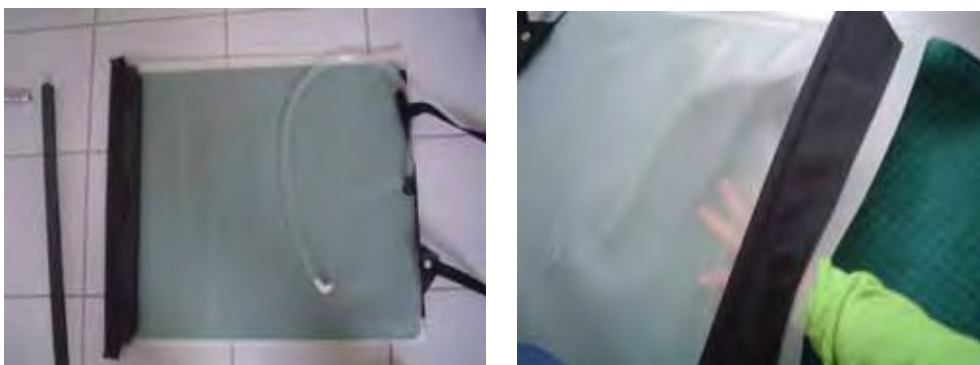
Figura 6 – Saco plástico do vácuo com cânula onde a bomba é conectada, e colocação do sensor dentro do saco do vácuo
