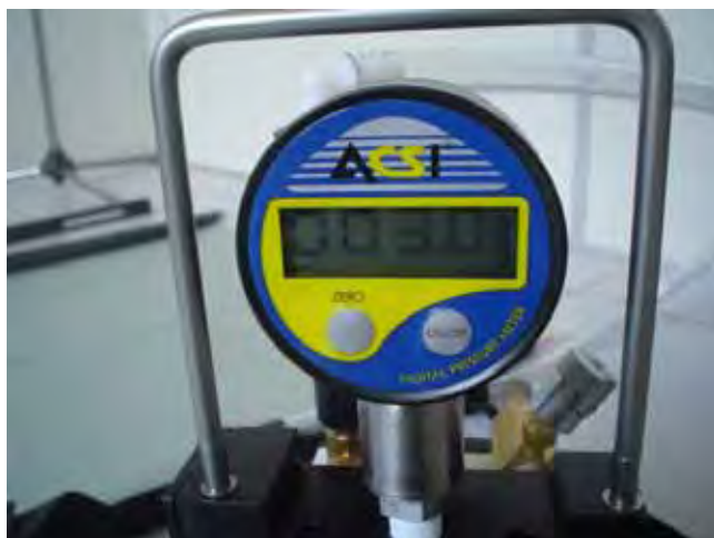
Figura 9 – Medidor localizado em cima da bomba de vácuo
