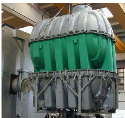
Figura 15- Representação de um molde cilíndrico usado no processo de rotomoldagem.
