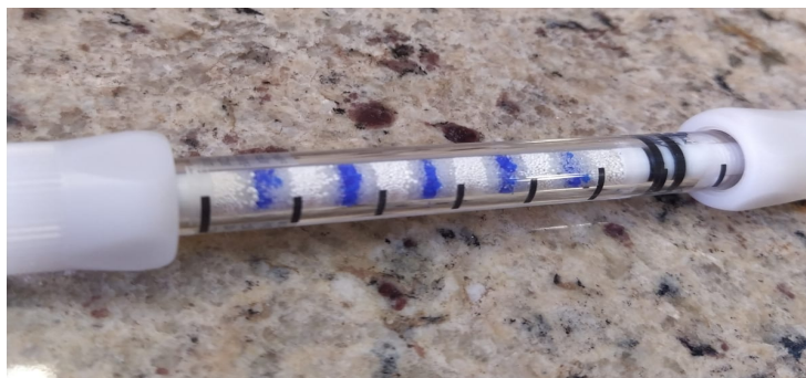
Figura 11. Coluna Omnifit® EZ Solvent Plus com o diâmetro interno de 6,6 mm e comprimento de 100 mm com camadas alternadas dos catalisadores.
