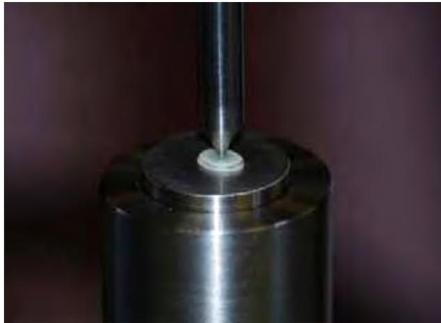
Figura 3 - Dispositivo para ensaio de *push-out* e amostra.
