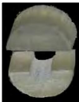
Figura 5 - Hemi-discos de resina reforçada por fibra com entalhe no hemi-disco inferior.
