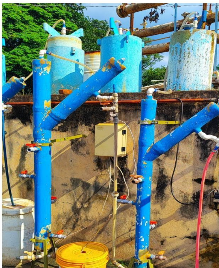
Figura 4. Representação esquemática e foto do sistema com os reatores anaeróbios UASB em série (R1 e R2) com adição de biochar.
