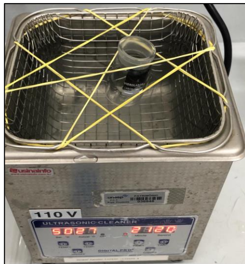
Figura 16: Solução de rGO no banho ultrassônico (Autora, 2022).
