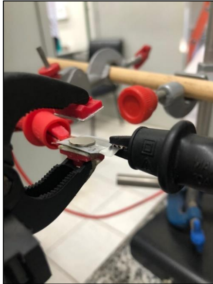
Figura 23: Esquema para compressão mecânica (Autora, 2022).
