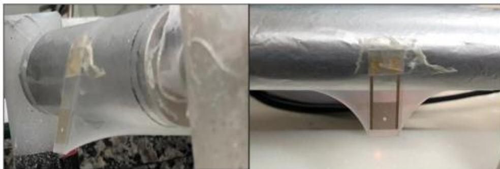
Figura 20: Substrato após formação das nanofibras (Autora, 2022).
