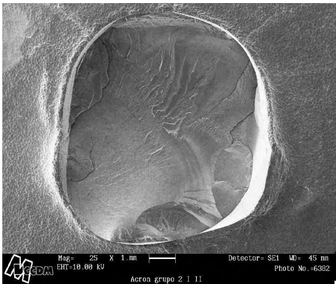
FIGURA 23- AC X DV correspondente ao G2 - falha coesiva.
