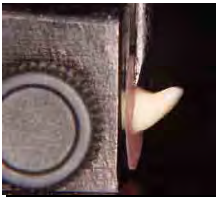
FIGURA 15- Amostra posicionada para o teste de cisalhamento.
