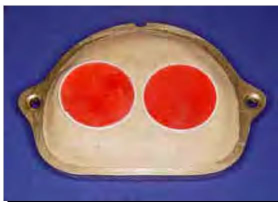
FIGURA 2- Anéis de PVC preenchidos com cera e incluídos na mufla.
