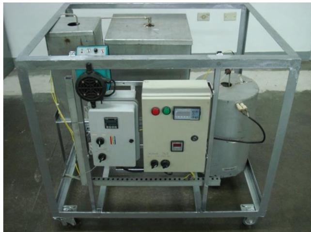
Figura 16: Reformador adaptado para a produção de hidrogênio a partir do biogás.
