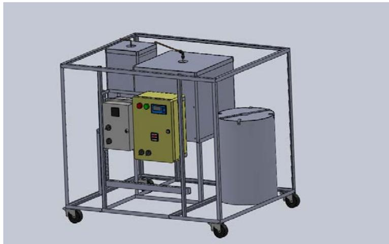
Figura 15: Desenho esquemático de um reformador a vapor.
