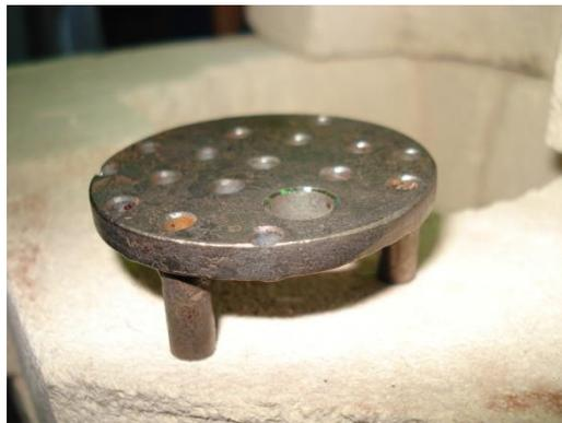
Figura 13: Base interna do gerador de vaporizador.
