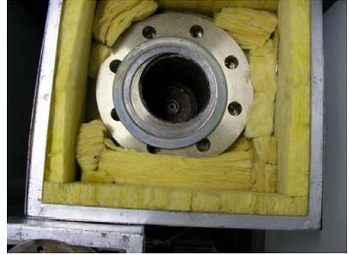
Figura 7: Reator de reforma - Leito catalítico.
