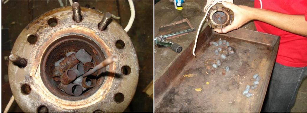
Figura 12 – a) e b) Retirada dos anéis de inox.
