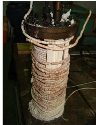
Figura 9: Resistência do Vaporizador.
