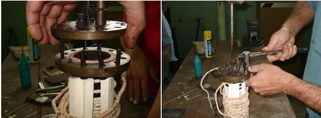
Figura 11 – a) e b) Abertura do vaporizador.
