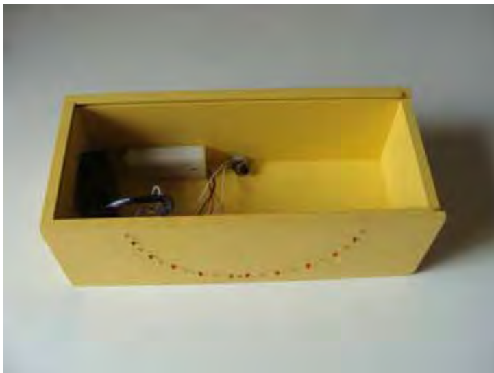
Figura 9 – Sistema de luzes (leds) e de som acionados por sensor de movimento.
