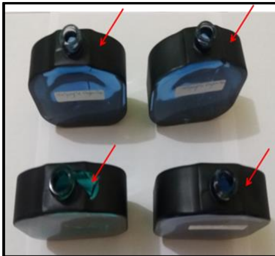
Figura 59. Fotografia das trincas observadas de cima
