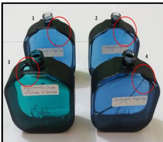
Figura 60. Fotografia das trincas observadas de frente (1, 2 e 4 Pintados; 3 Color Feeder)
