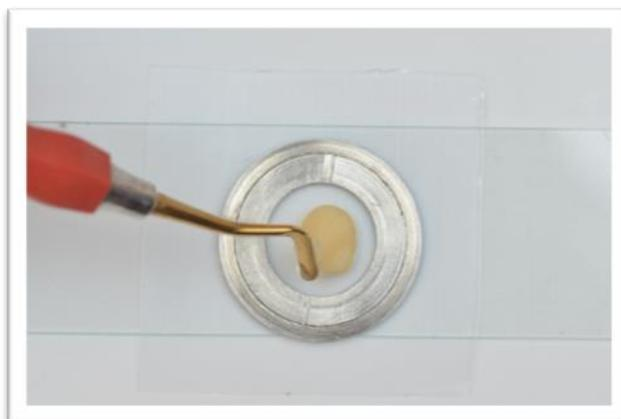
**Figura 3-** Matriz entre dois filmes plásticos e duas lâminas de vidro, mantidas sob a pressão digital durante a polimerização.
