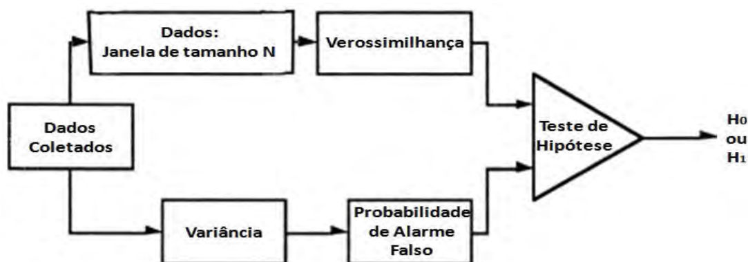
Figura 2 – Procedimento para teste de hipótese CBM (MA; LI, 1995)
