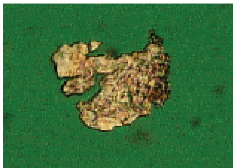
Figura 13 – Exemplo de partícula de desgaste por fricção (LUBROSOFT, 1997)
