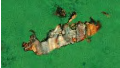
Figura 16: Exemplo de partículas de desgaste por deslizamento severo (LUBROSOFT, 1997)
