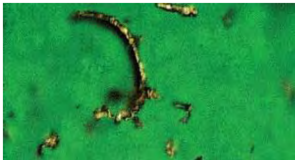
Figura 14 – Exemplo de partículas de desgaste por abrasão (LUBROSOFT, 1997)
