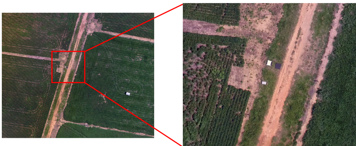
Figura 19 – Alvos de referência no processo de calibração por linha empírica.
