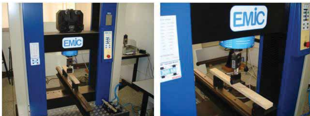
Figura 9 – Ensaio de flexão estática em relação ao eixo de menor inércia.
