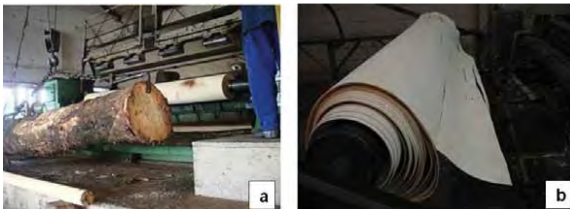
Figura 3 – Laminação das toras: (a) torno industrial; (b) bobina, tora desenrolada
