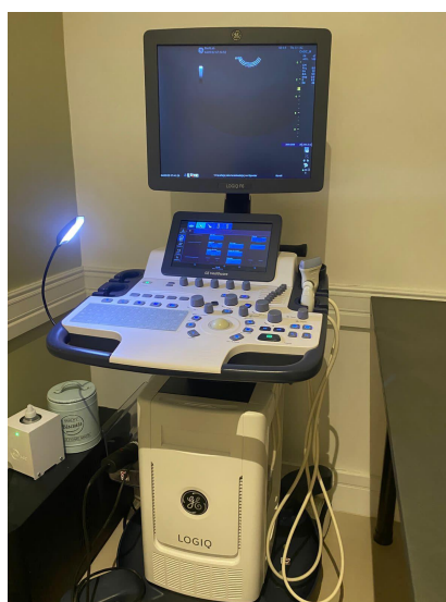
Figura 2. Aparelho ultrassonográfico da GE Healthcare , modelo Logiq F6, equipado com um transdutor linear e um microconvexo do Centro de Diagnóstico Veterinário BadiLab.
