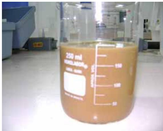
**Figura 8** - Efluente bruto proveniente do processo da extração do óleo de dendê.
