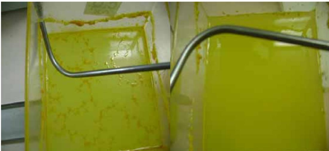
**Figura 11** - Vista superior do jarro mostrando a influência da ausência (esquerda) do surfactante e da presença (direita) do mesmo na formação de emulsão.
