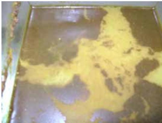
**Figura 12** - Parte dos sólidos mantém-se agregados ao óleo na forma livre.
