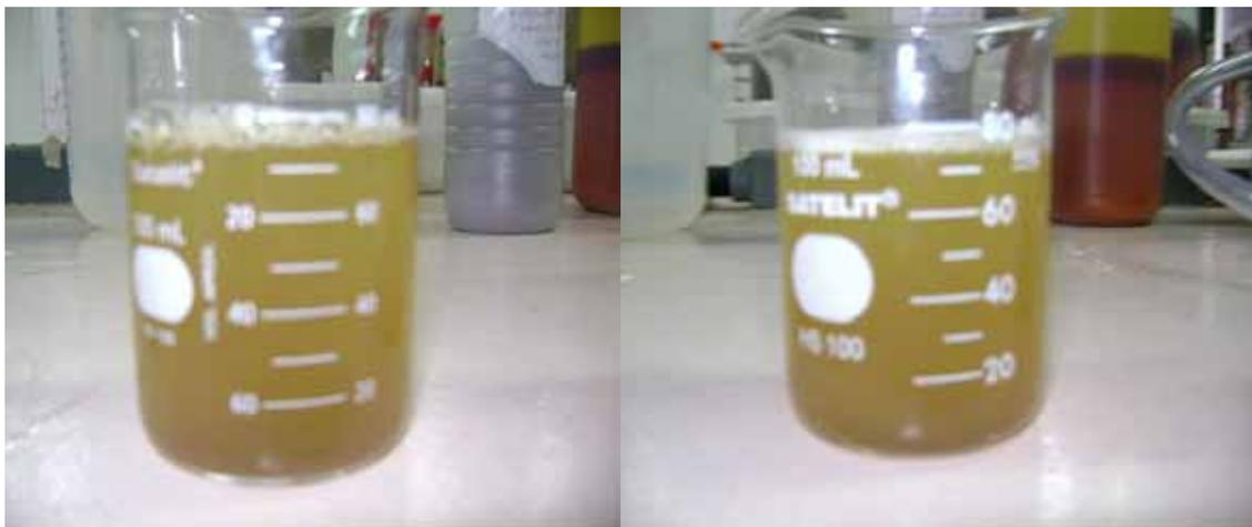
**Figura 13** - Análise visual da estabilidade das emulsões. Os tempos de repouso foram de 15 e 60 minutos para a amostra da esquerda e a da direita, respectivamente.
