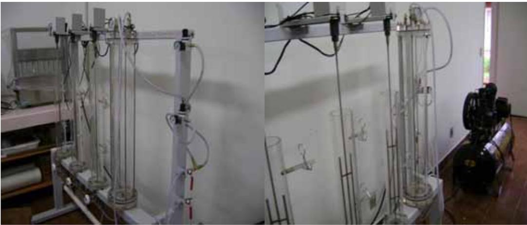
**Figura 6** - Flotateste utilizado nos ensaios de floculação e flotação.
