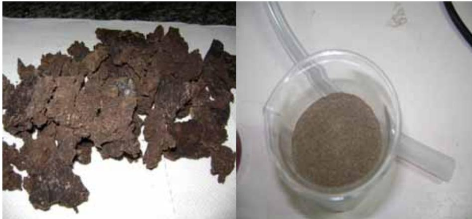
**Figura 4** – À esquerda, sólido seco proveniente do processamento do óleo de dendê. À direita, o mesmo sólido porém britado para utilização em laboratório.
