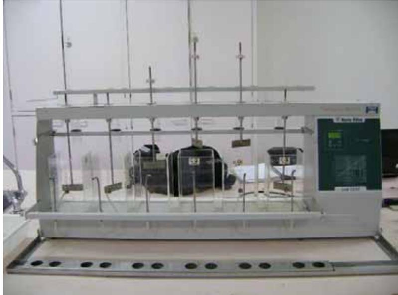
**Figura 5** - Jarreste utilizado nas etapas de simulação do efluente e somente na mistura rápida para os ensaios de coagulação, floculação e flotação.
