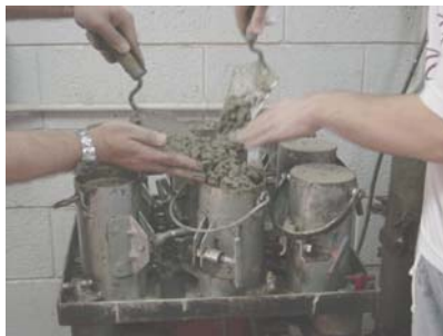
Figura 4.20 - Adensamento do concreto
