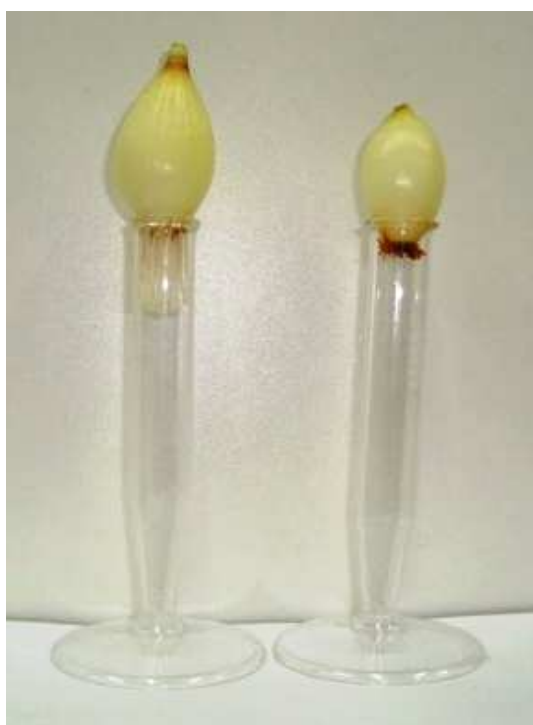
Figura 32. Esta figura ilustra o tamanho das raízes de um dos bulbos de Allium cepa utilizados no teste de toxicidade após o processo de bioissorção, a direita temos um dos bulbos utilizados no controle negativo (água mineral) e a esquerda um dos bulbos que permaneceu em contato com a solução do corante Chrysoidine.
