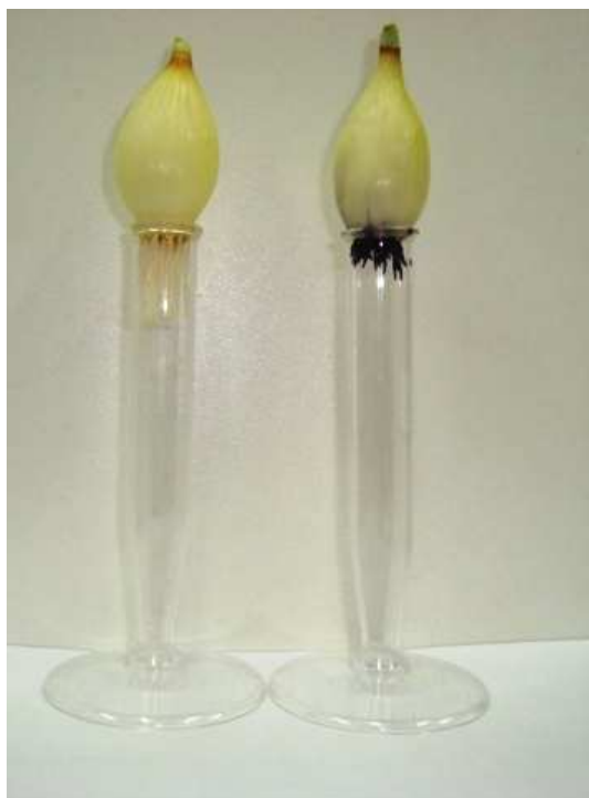
Figura 31. Esta figura ilustra o tamanho das raízes de um dos bulbos de Allium cepa utilizados no teste de toxicidade após o processo de bioissorção, a direita temos um dos bulbos utilizados no controle negativo (água mineral) e a esquerda um dos bulbos que permaneceu em contato com a solução do corante Direct Violet 51.
