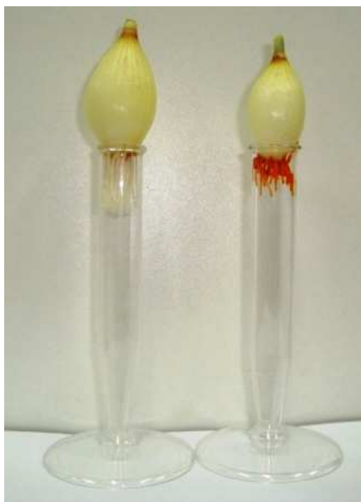
Figura 30. Esta figura ilustra o tamanho das raízes de um dos bulbos de Allium cepa utilizados no teste de toxicidade após o processo de bioassorção, a direita temos um dos bulbos utilizados no controle negativo (água mineral) e a esquerda um dos bulbos que permaneceu em contato com a solução do corante Acid Orange 7.
