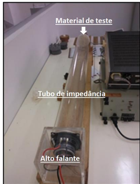
Figura 17b – Tubo de Impedância com alto falante e o material de teste
