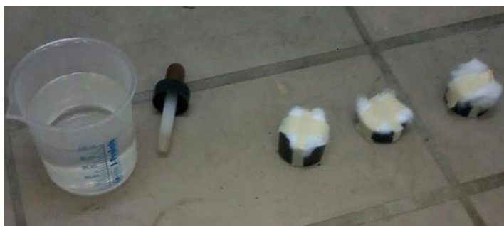
Figura 38 – Preparação para o ataque do reagente Keller nos CDPs.
