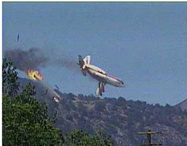
Figura 21 – Lockheed C130 perdendo as asas por falha das longarinas.
