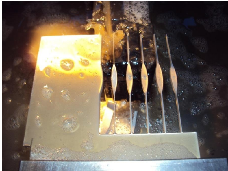
Figura 31 – Confeccção dos CDPs de tração e fadiga por eletro-erosão a fio.
