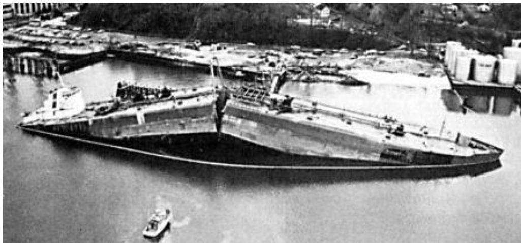
Figura 28 – Fratura frágil ocorrida em um navio de carga Liberty que separou o navio em duas partes em 1941.
