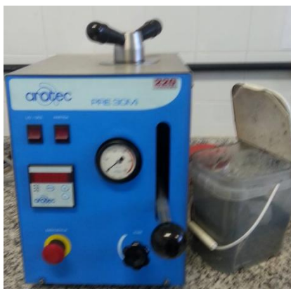
Figura 35 – Máquina de formação dos moldes de baquelite.
