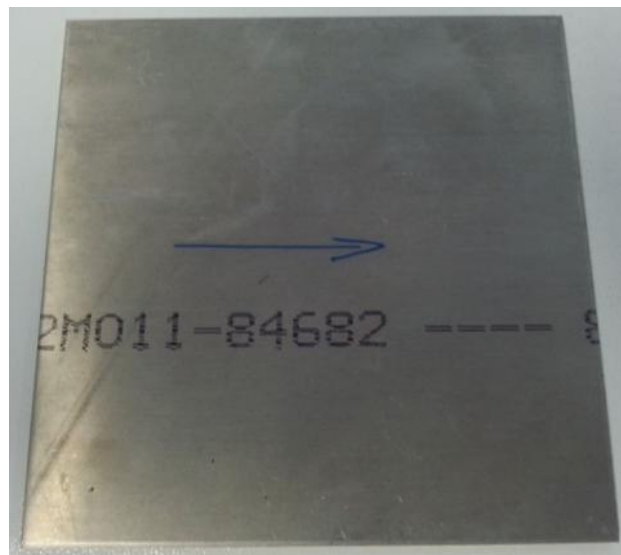
Figura 34- Chapa da liga 7475 – T761 usada para análise metalográfica e sentido de laminação indicado.
