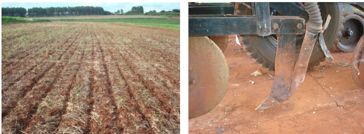
Figura 23. Vista geral da área experimental com os sulcos de semeadura previamente abertos e distribuição do fertilizante (esquerda) e detalhe do mecanismo sulcador de hastes (direita). Selvíria – MS, Brasil (2009).
